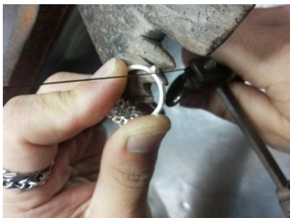
(ภาพที่12 นำใบเลื่อยมาเลื่อยตุ้ม)
