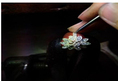
(ภาพที่ 18 นำเหล็กปั่นมากดพลอย)
