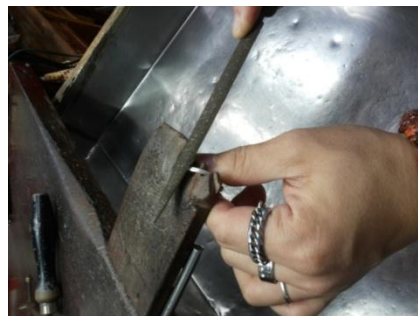
(ภาพที่ 13 นำตะไบมาตะไบตุ้มให้เรียบ)
