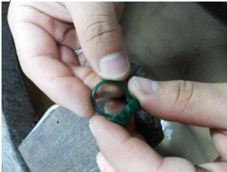
(ภาพที่ 11 นำก้านแหวนมาติดกับดอก)
