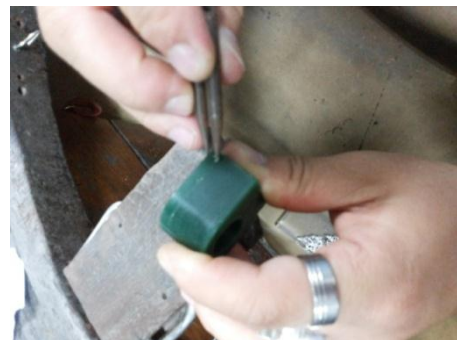
(ภาพที่ 8 ใช้วงเวียนมาขีดwax)
